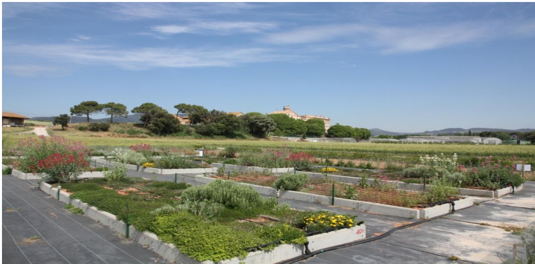
Foto IRTA: Mostres de diversos models de cobertes verdes que s'estudien en el projecte CUMED, a l'IRTA de Torre Marimon (Caldes de Montbui, Barcelona).
